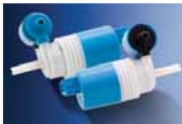
**Función:** Bombear el agua desde el depósito limpiaparabrisas, a través de los conductos y atomizadores (chisgueteros) para mantener siempre limpio el cristal y ofrecer una visión clara sobre la calzada.
